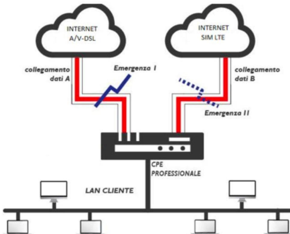
In caso di interruzione della linea dati via cavo, dopo pochi secondi il traffico viene AUTOMATICAMENTE dirottato sulla SIM LTE che consente al cliente di continuare l'operatività interna.
